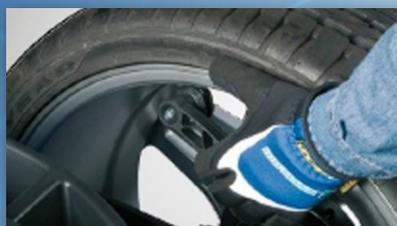
Los mecánicos no tienen más que tocar la llanta con el brazo calibrador, y el sistema introduce automáticamente las dimensiones de la llanta y selecciona el modo de equilibrado de peso adecuado.
